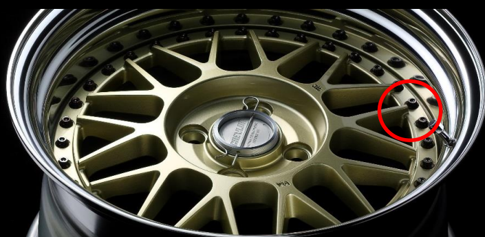
シェブロンレーシング "OH" (ピアスポルト下はディスク)
