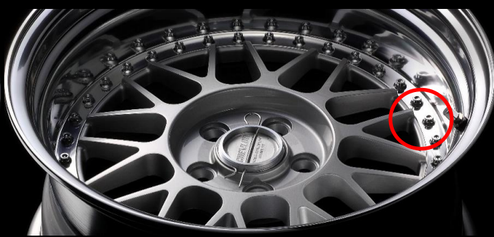
シェブロンレーシング "UH" (ピアスポルト下はアウターリム)
