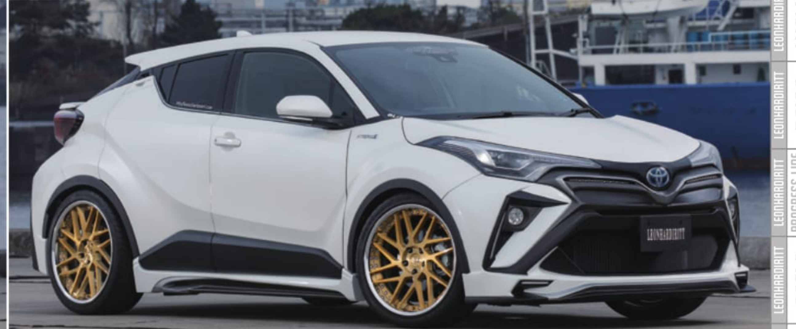
TOYOTA C-HR WHEEL: Geist(FACE1) COLOR: GOLD CLEAR BRUSHED RIM: SHINING BRIGHT(REVERSE) PIERCE BOLT: CHROME HOLES: 5 P.C.D.: 114.3 SIZE: F 2090 INSET 48 R 2090 INSET 42 TIRE: F 245/35-20 R 245/35-20 ※ローダウンが必要です。
