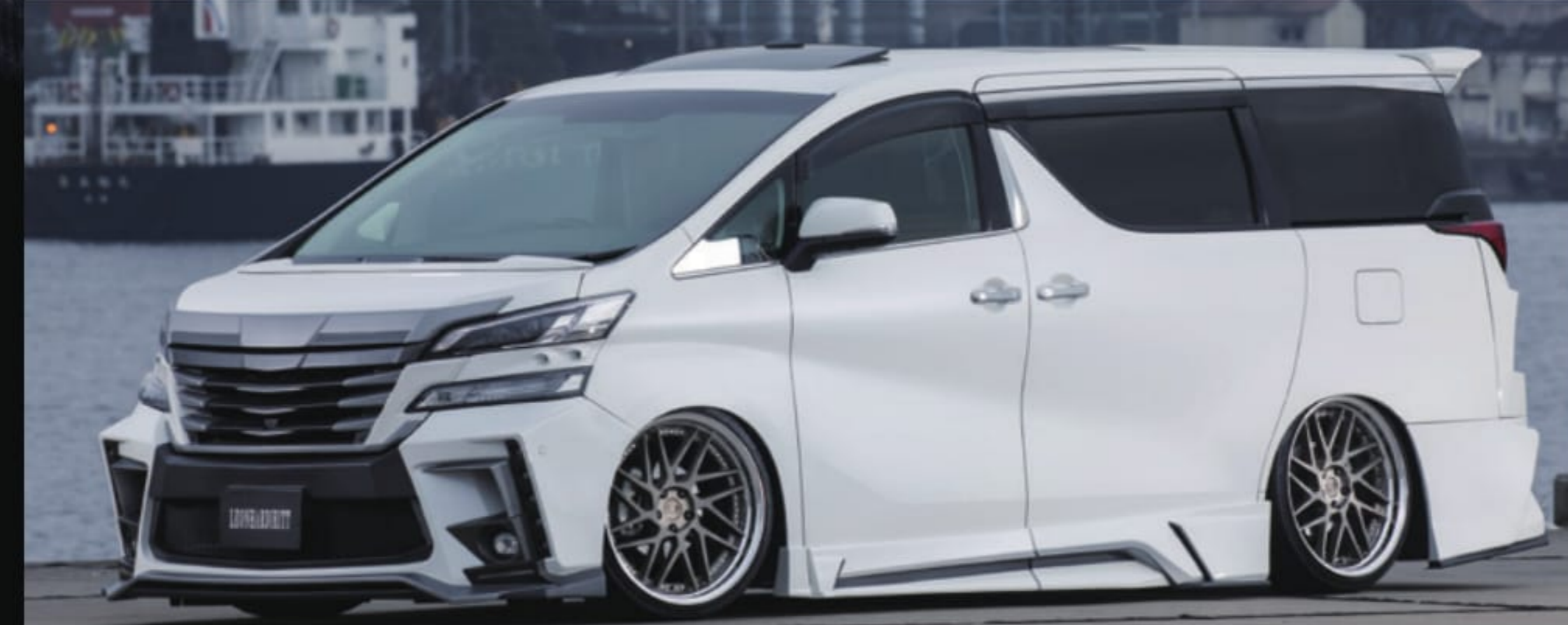
TOYOTA 30 VELLFIRE WHEEL: Geist(FACE1) COLOR: MATTE BRONZE BRUSHED RIM: SHINING BRIGHT(NORMAL) PIERCE BOLT: CHROME HOLES: 5 P.C.D.: 114.3 SIZE: F 2195 INSET 28 R 2195 INSET 35 TIRE: F 255/30-21 R 255/30-21 ※ローダウンが必要です。
